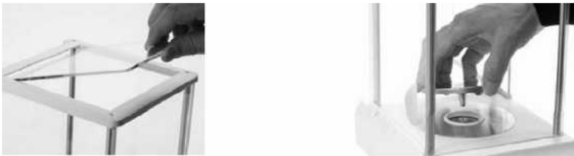
Lắp kính chắn phía trên và dưới cân.
